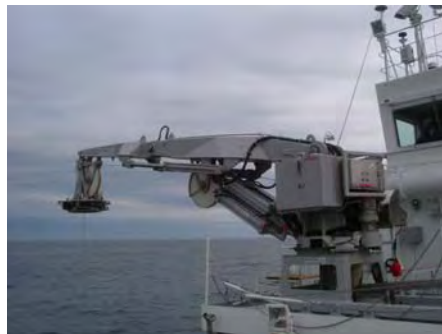
写真2. ヒープモーションクレーン
