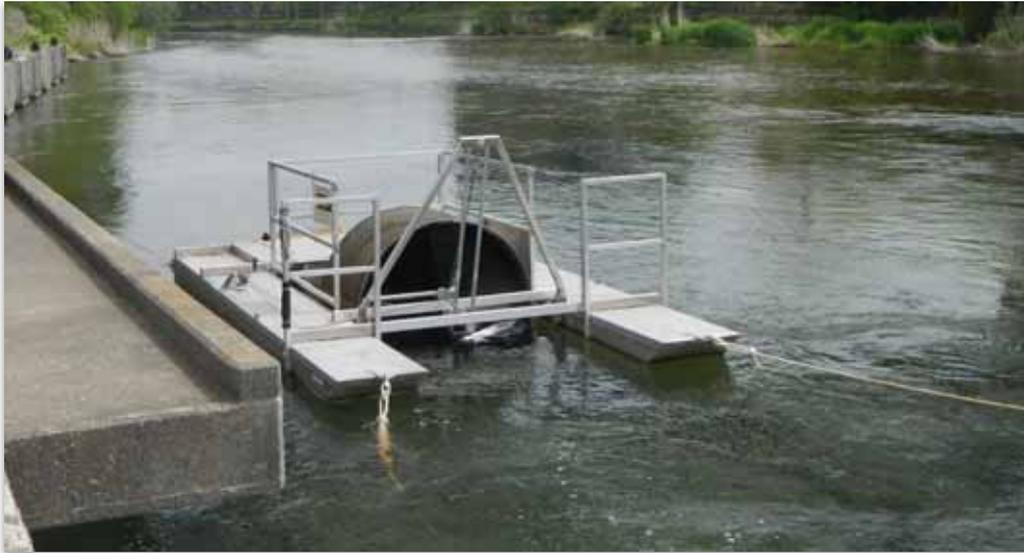
図2. 2017年春期千歳川調査において用いたロータリースクリュートラップの設置状況
