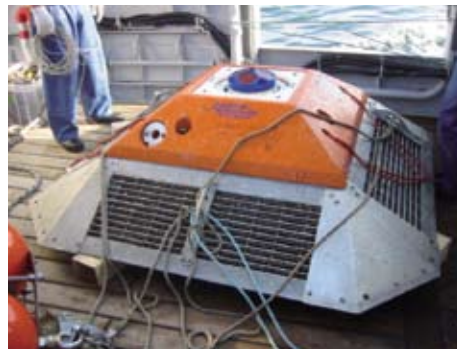
海底設置型流向流速計（ADCP）の設置風景
