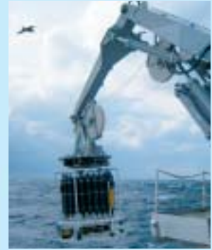
CTDセンサーとニスキン採水器(栄養塩等の分析用の試水採取)の組み合わせ装置(北光丸)
